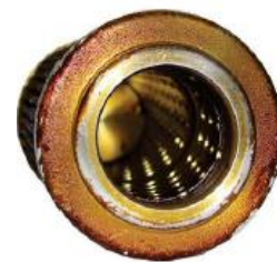
Depósitos de barniz en el elemento filtrante (GE Estructura 6B)
